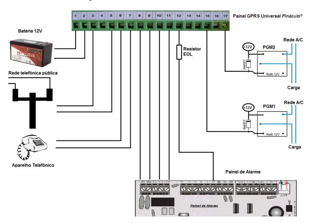
Conforme a figura acima, os terminais de conexão do **GPRS Universal** *Pináculo*<sup>®</sup> têm 17 posições com numeração iniciando a partir da esquerda:
