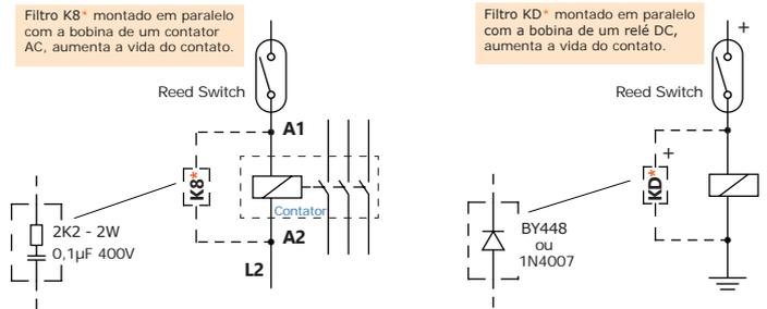
Filtro K8\* montado em paralelo com a bobina de um contator AC, aumenta a vida do contato.
