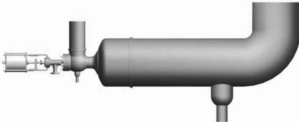
**Figura 12 – Válvula instalada em posição baixa**
