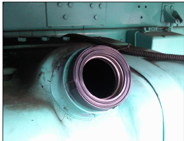
Remover o anel de vedação que esta no bocal e assenta-lo de maneira firme na boca do tanque. **OBS. O bocal 1 é instalado diretamente com o anel de vedação.**
