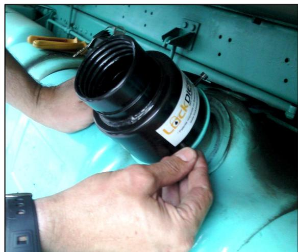
Em Seguida coloque os parafusos especiais que fazem parte do kit que acompanha o bocal, utilizando a chave Allen que também faz parte do kit, aperte os parafusos até o ponto em que a parte mais fina do parafuso fique rente ao bocal. Com o auxílio da chave Allen movimente o parafuso para os lados até que se quebre.
