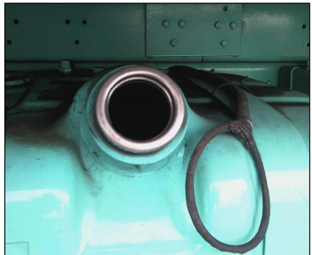
Remover a tampa do tanque e se o veículo possuir sistema de controle de abastecimento (CTF), remover a "antena" com cuidado.
