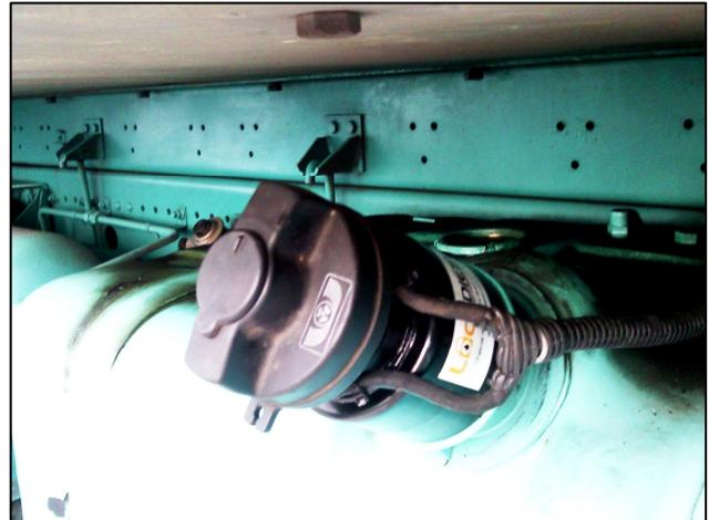
O bocal **Lockdiesel** possui um "rebaixo" que facilita a instalação da antena do sistema de controle de combustível (CTF). Recoloque a antena fixando-a com o auxílio de presilhas plásticas.
