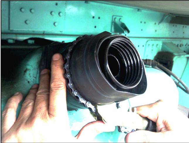
Encaixar o bocal **Lockdiesel** de maneira firme na boca do tanque e utilizando uma proteção para não danificar o bocal, parafuse-o com firmeza. Para facilitar a instalação sugerimos a utilização de uma chave de apertar/desapertar filtros de óleo.
