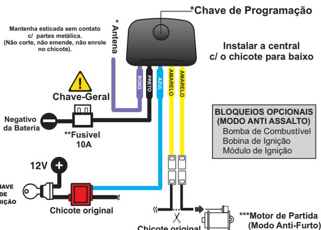
\*\*\*A instalação sendo feita no automático do motor de partida, o bloqueio ocorrerá somente após desligar a ignição, não ocorrendo o bloqueio com o veículo em movimento. Recomendado Conf. NBR 13042/1993
