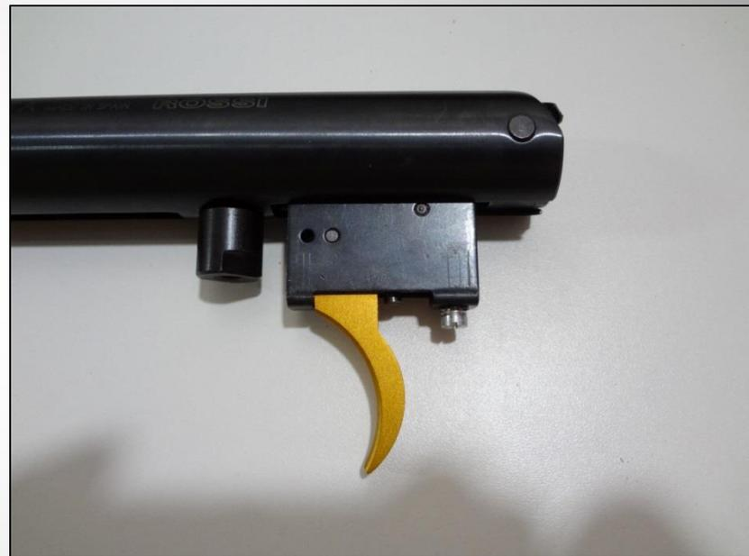
Com o parafuso retirado do gatilho original encaixado, agora instale a nova lâmina, colocando o pino no furo indicado pela seta.
