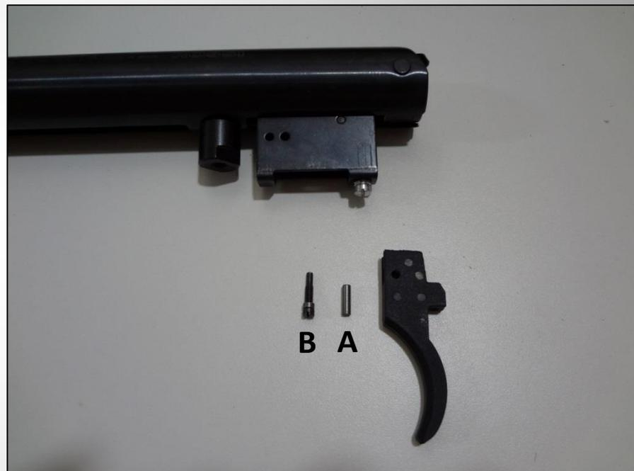
Com uma chave de fenda pequena ou uma chave de ponta fina, remova o pino (A) ilustrado na foto. Ao remover o pino, a lâmina de gatilho original será liberada. Retire completamente a antiga lâmina da caixa de gatilho e retire também o parafuso de ajuste (B) do gatilho original para utilizar na nova lâmina de gatilho.
