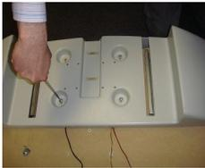
Desmontar a capa do gabinete da parte inferior do tampo, chave philips 3/16”.
