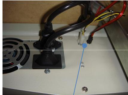
Estes cabos já vêm pré-instalados de fábrica. São os cabos da placa de som e do botão liga/desliga que estão fixados no tampo.
