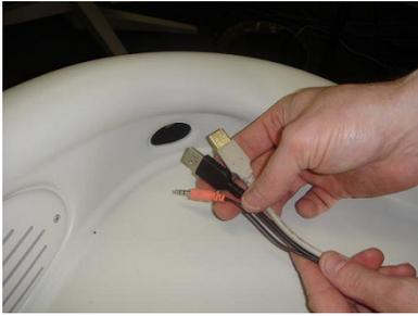
Passar o cabo do mouse, do microfone e do módulo pelo orifício no canto do tampo.
