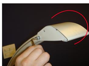
A câmera não precisa ser montada, apenas os parafusos deverão ser apertados após o ajuste. Chave Allen 3/16”.
