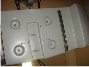
Fixar a capa do gabinete, previamente montada com os cabos, no tampo.
