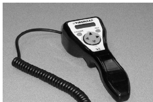
Figura 22. Unidade portátil de controlo
