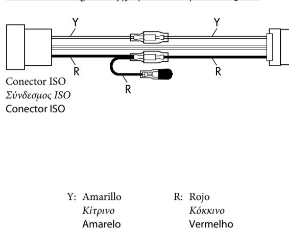
Conexionado modificado 1 / Τροποποιημένη καλωδίωση 1 /
