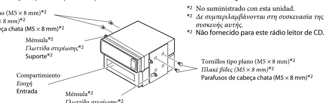
**Nota :** Cuando instala la unidad en la ménsula de montaje, asegúrese de utilizar los tornillos de 8 mm de longitud. Si se utilizan tornillos más largos, éstos pueden dañar la unidad.
