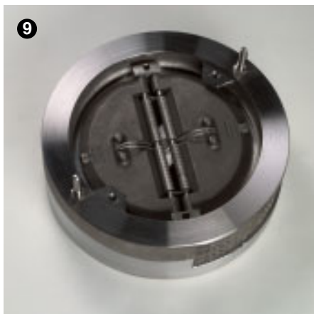
9 Alinhar os pratos semicirculares, inserir e apertar o parafuso de fixação
