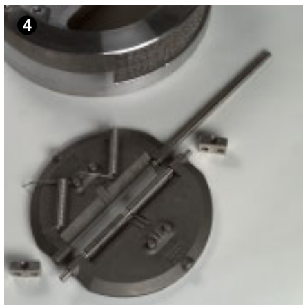
Remover o suporte dos pratos, as molas e o suporte da cavilha
