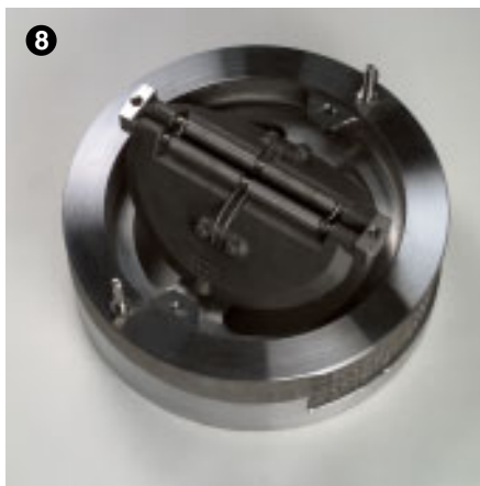
Inserir os pratos semicirculares com molas e o suporte dos pratos
