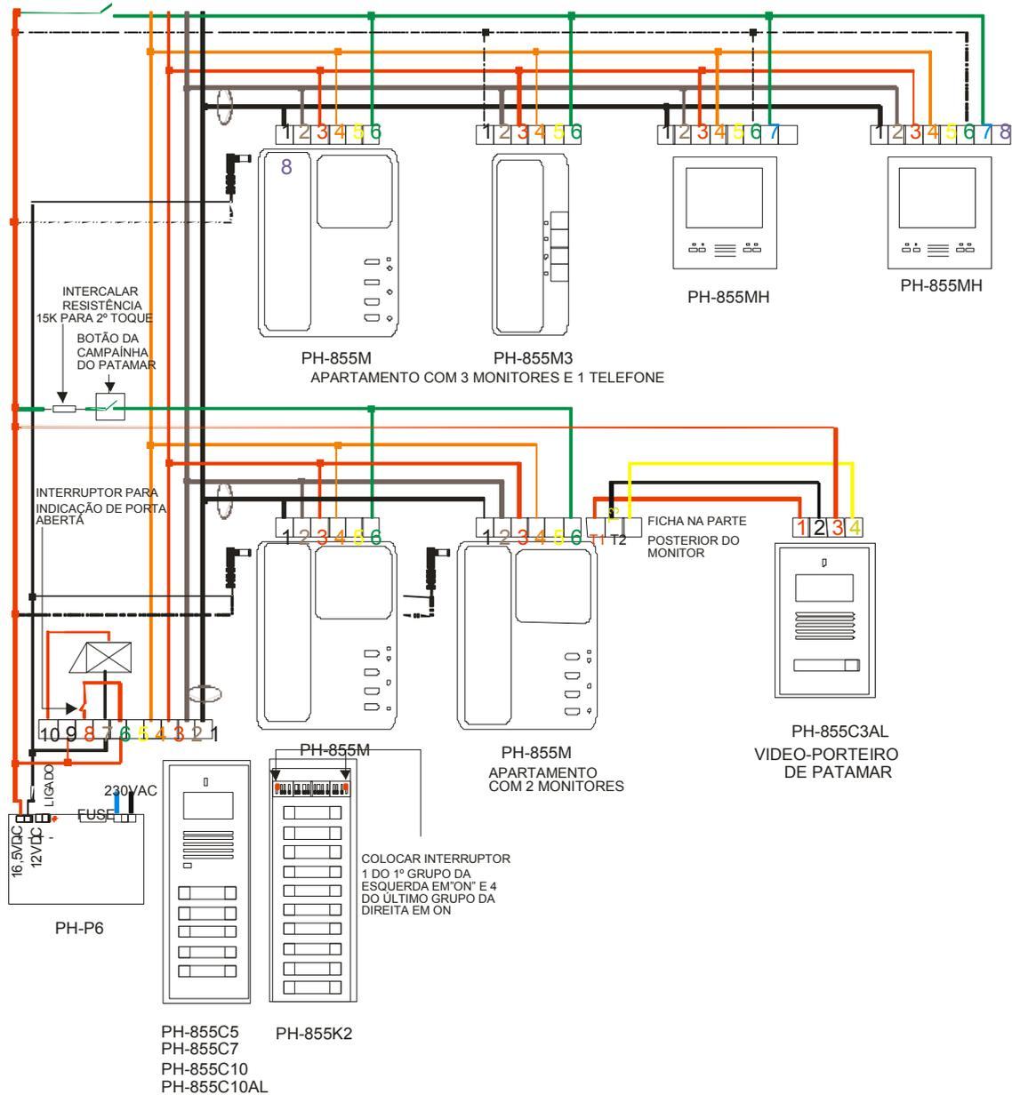
1 - Instalação a 4 fios de 1 mm (mínimo) e cabo coaxial RG59 (75 Ohms).
