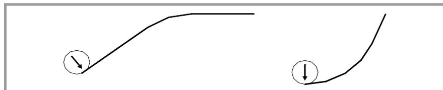
2. A interpolação dos eixos do plano começa depois que o eixo tangencial está posicionado.
