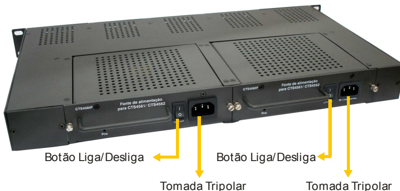
Figura 2.4-1: Vista do painel traseiro do Channel Bank.
