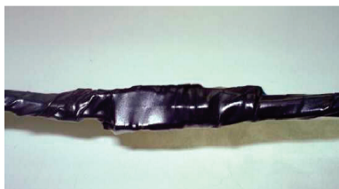
Figura 5 - Rastreador camuflado com Fita Isolante
