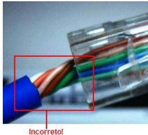
As características de uma crimpagem perfeita é quando além do cabo funcionar perfeitamente, a capa plástica foi pressionada corretamente no lugar e está encaixada até o limite e todos os fios sem exceção estão na ponta do conector e nenhum fio que está dentro do conector se apresenta sobrepondo qualquer outro fio.
