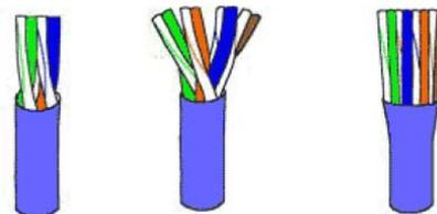
Após a realização desse passo, é necessário encaixar o conector RJ-45, fazer com que cada fio entre no orifício correspondente.
