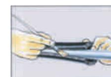
instale o Armaflex na tubulação e aplique o adesivo sobre a face do corte
