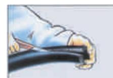
Seção em T: Corte longitudinalmente uma seção e faça um orifício do tamanho do diâmetro.
