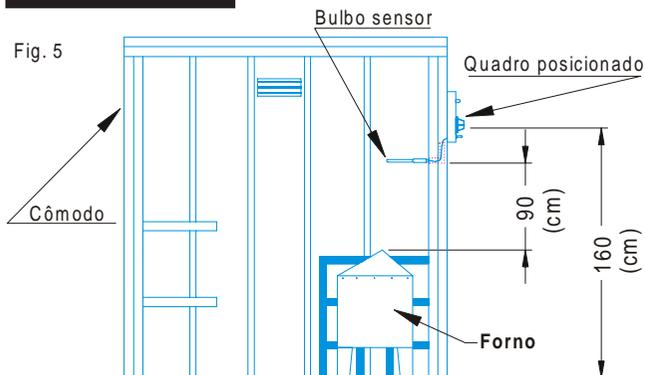
**OBS:** O bulbo deve permanecer perpendicular em relação à parede, e acima do forno na dimensão especificada.
