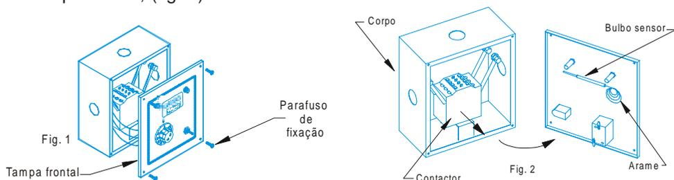
Com o quadro de comando aberto, desencaixe o contactor puxando-o para fora do corpo, em seguida retire o bulbo sensor, desenrolando seu arame e passando pelo conduíte até o interior do cômodo (fig. 5), para então fixar a tampa frontal na parede externa da seguinte forma:
