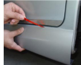
**B) Descole e dobre a fita protetora da ponteira de acabamento, aplique o primer e conclua a colagem puxando toda a fita protetora, fazendo a pressão para melhor aderência.**
