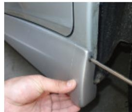
Em seguida usando a peça já furada como guia, fure a borda lateral do veículo com broca 2,5mm coloque os parafusos e atarraxe moderadamente, sem apertar deixando um alívio para a movimentação da peça. **ATENÇÃO:** lembre-se que a peça é de plástico.
