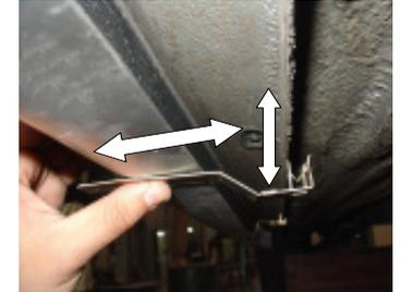
**Corte ou entorte o excesso de chapa,** coloque as chapas por dentro do spoiler depois fure somente a peça nos pontos marcados com broca 4,0mm. Fixe-as com parafuso. Obs.: Se necessário faça novos furos na chapa de fixação.
