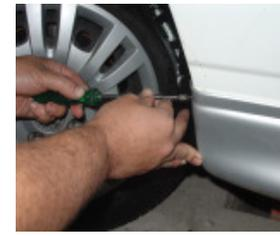
**BORDA DIANTEIRA:** Para furar e parafusar a borda dianteira esterce o pneu. Em alguns veículos para fixar a borda dianteira, é necessário soltar a capa plástica e encaixar entre a lata e a capa, depois fixe a peça usando o próprio parafuso da capa plástica.
