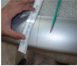
Serre na marcação e dê acabamento no corte com estilete, lixa ou lima.
