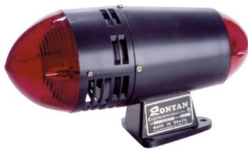
A sirene RT15 é montada em um corpo de chapa de aço pintada nas cores branca ou preta, flange de alumínio, base de fixação de alumínio e hélice injetada em nylon com fibra de vidro. Possui lâmpadas de alerta na parte frontal e traseira com lentes de acrílico rubi.
