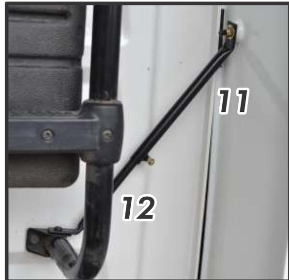
**10)** No lado esquerdo fixe o extensor **8** no parafuso do filtro, como mostra a imagem. Fixe o extensor **9** no espaço reservado no centro da lateral inferior utilizando: 1 parafuso fenda cruzada 8x25mm preto na parte externa; e na parte interna 1 arruela lisa 8mm e 1 porca auto-travante 8mm. Poda dar o aperto e contra-aperto entre os extensores utilize 1 parafuso sextavado 6x16mm e 1 porca sextavada 6mm.
