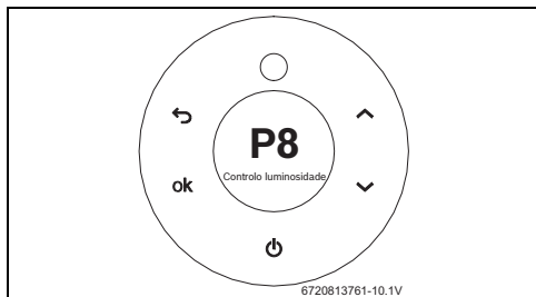
Fig. 13 P8 - Controlo de luminosidade
