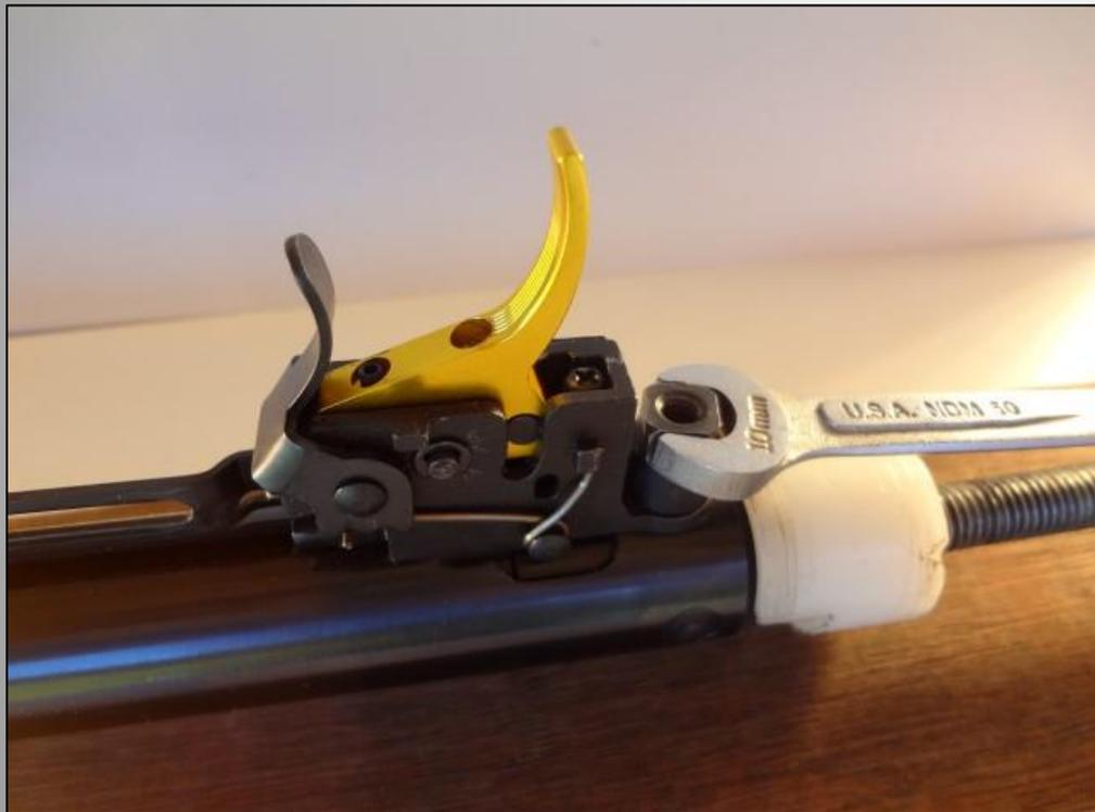
Com uma chave de boca nº 10, aperte o parafuso da culatra, próximo ao sistema de gatilho.
