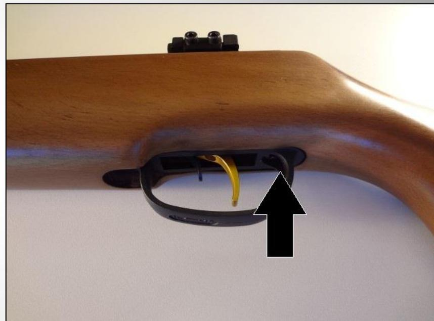
Com chaves adequadas a sua carabina (Philips ou fenda), remova os três parafusos da coronha para separar a coronha da mecânica da carabina. Dois parafusos estão localizados nas laterais e o último no guarda-mato.
