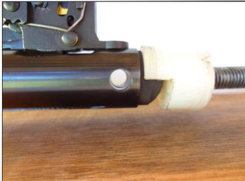
Cuidadosamente, aperte o parafuso do compressor de molas pressionando o conjunto até posicionar a culatra nos pontos de fixação.
