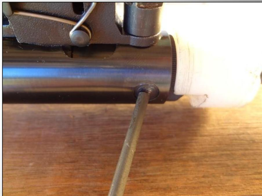
Utilizando uma chave de boca nº 10, remova o parafuso de travamento do sistema de gatilho na culatra.
