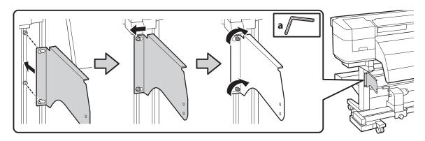
Fixe um lado da barra do guia de papel usando dois parafusos.
