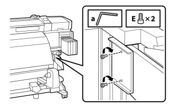
3. Coloque um parafuso no suporte de montagem de guia de papel.
