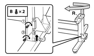
6. Prenda temporariamente o suporte do tubo de resíduo de tinta usando um parafuso B.
