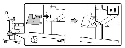
**5**. Prenda um parafuso B do outro lado do suporte, mova a peça deslizante para arriba e prenda o outro parafuso B.
