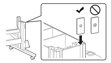
Deslize as peças de montagem nos encaixes, conforme mostrado.
