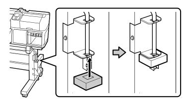
14. Instale o tanque de resíduo de tinta no suporte. Certifique-se de que o tubo de resíduo de tinta esteja inserido na abertura. Empurre a prevenção de derramamento de tinta para baixo para cobrir a abertura do tanque de resíduo de tinta.
