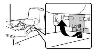
Conecte o cabo de comunicação e passe-o pelos suportes do cabo. **7**.
