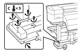
Prenda a extremidade direita a unidade de enrolamento na base usando quatro parafusos C.
