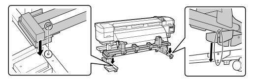
Prenda a extremidade esquerda a unidade de enrolamento usando cinco parafusos C, conforme mostrado.
