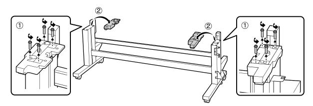
Deslize a peça de montagem no slot, como mostrado. 8.
