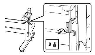
7. Remova os quatro parafusos da cada perna e depois remova as peças de plástico.
