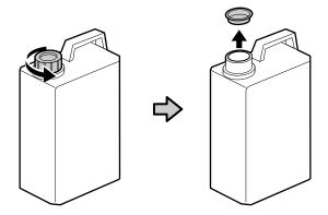
**Observação:** Guarde a tampa e o lacre interno do tanque de resíduo de tinta. O tanque deve ser vedado de maneira adequada para o descarte.
