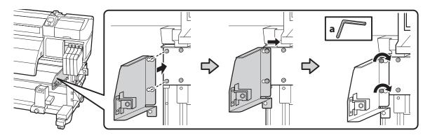
2. Coloque dois parafusos no suporte de montagem de guia de papel.
