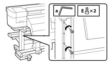
Coloque o suporte sobre os parafusos, mova para a esquerda, depois aperte os parafusos.
