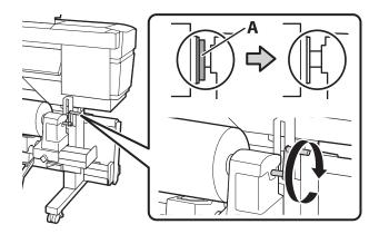
10. Puxe o papel para dentro da impressora. Se a extremidade esquerda do papel não estiver cobrindo parcialmente a área retangular mostrada na figura à direita, retorne ao passo 4.
