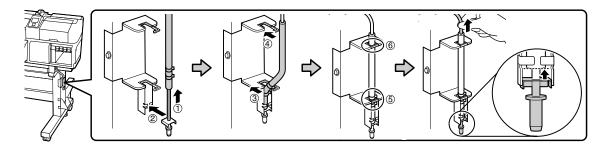
12. Remova a tampa e lacre interno do tanque de resíduo da tinta.
