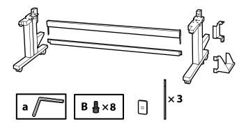
1. Remova a fita adesiva do suporte horizontal maior e depois deslize a haste do suporte dentro das pernas.
