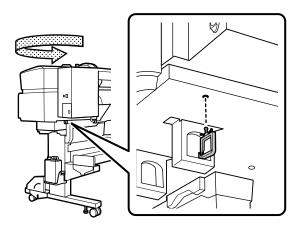
Passe os cabos de eletricidade pelos suportes do cabo. Conecte o cabo de eletricidade à impressora e use os suportes de cabo para prender o cabo.
