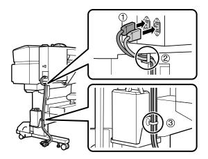
Conecte a impressora a uma tomada devidamente aterrada. Duas tomadas são necessárias para um total de 20 amps. Recomenda-se que as tomadas sejam supridas por um circuito dedicado de 30 amps.
