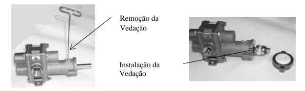
3) Coloque novas gaxetas ou anéis-O na base da vedação e instale na prensa-estopa.
