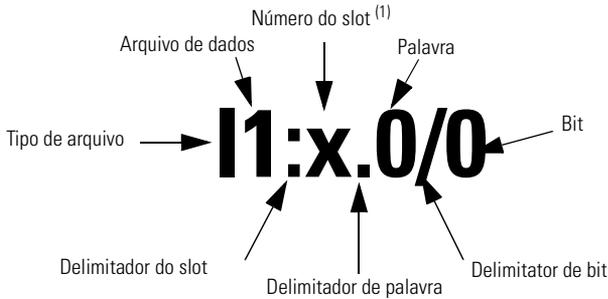
(1) A E/S localizada no controlador (E/S embutida) é o slot 0. A E/S adicionada ao controlador (expansão de E/S) começa com o slot 1.
