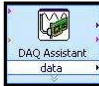
Através do bloco DAQ ASSISTANT é possível adquirir, ou enviar dados para um sistema de aquisição de dados. O DAQ ASSISTANT pode ser editado e configurado.
