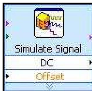
O simulador de sinais gera formas de onda senoidal, quadrada, triangular, dente de serra e sinal contínuo. Um duplo clique sobre seu bloco abre a janela de configuração do simulador de sinais (figura 10). Nesta janela deve-se escolher o tipo de sinal, a frequência, amplitude, offset, taxa de amostragem, etc. Este bloco serve para simular/gerar sinais para outros blocos do LABVIEW.
