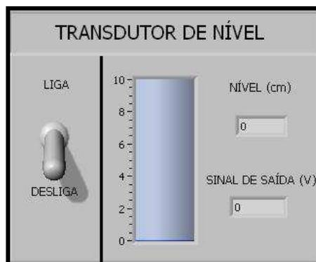
**Figura 8 – Painel de controle do transdutor de nível.**
