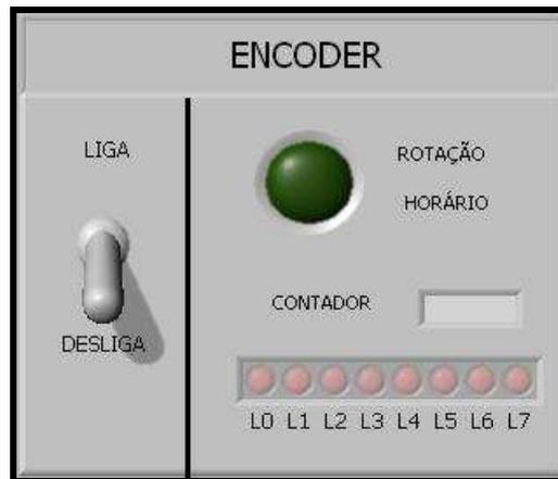
**Figura 20 – Painel de controle do encoder.**
