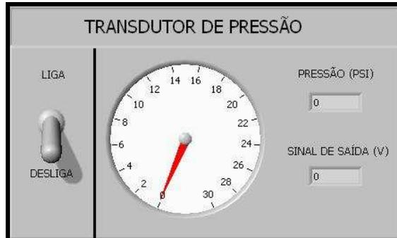
**Figura 16 – Painel de controle do transdutor de pressão.**
