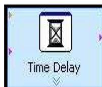
Especifica a espera de tempo em um aplicativo. Geralmente é utilizado junto com blocos de repetição.
