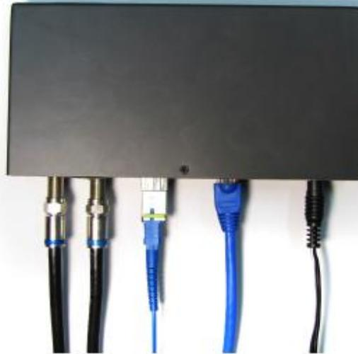
**Figura 3.2-1:** Conexão da fibra, do cabo UTP e cabos coaxiais.
