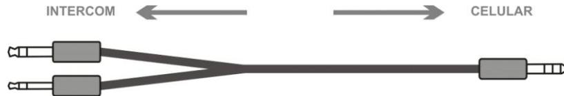
Ilustração de um adaptador de telefone celular.
