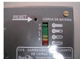
**LEDs Verdes:** Indicam o estado da carga da(s) baterias enquanto carregadas ou em plena carga.
