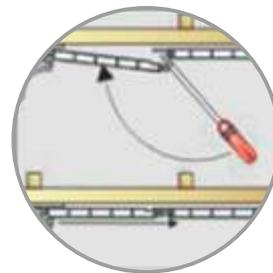
Encaixar o forro até o final do acabamento. Com o auxílio de uma espátula, fixar o engate "macho" no engate "fêmea" da lâmina anterior.
