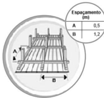
Os perfis de forro de PVC são fixados por meio de uma estrutura de sustentação suspensa, fixada previamente ao teto. Para montá-la, siga tabela abaixo.
