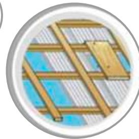
Colocar uma base de apoio para sustentar lustres, ventiladores, dentre outros equipamentos.
