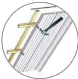
Encaixe a lâmina com o lado aparente voltado para baixo e o engate "macho" virado para o fundo, dentro dos acabamentos na parte lateral empurrando-a até seu encaixe total. Fixe a lâmina nos elementos de armação, através da aba. Para a fixação: prego 10x10, rebite ou grampo.
