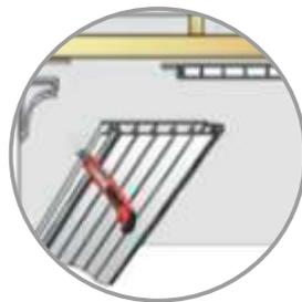
Para colocação da última lâmina, refile a lâmina na largura entre o fundo do acabamento e o encaixe da "fêmea", se for necessário.
