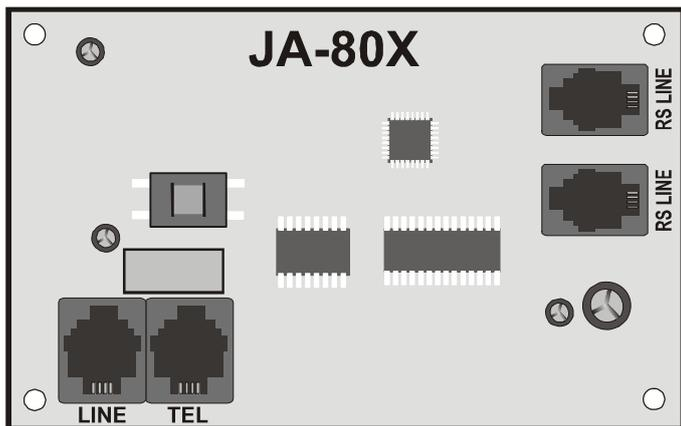
**Nota:** O comunicador deve ser conectado directamente a uma tomada de linha telefónica. Todos os outros dispositivos devem ser conectados à saída comunicador marcada TEL.
