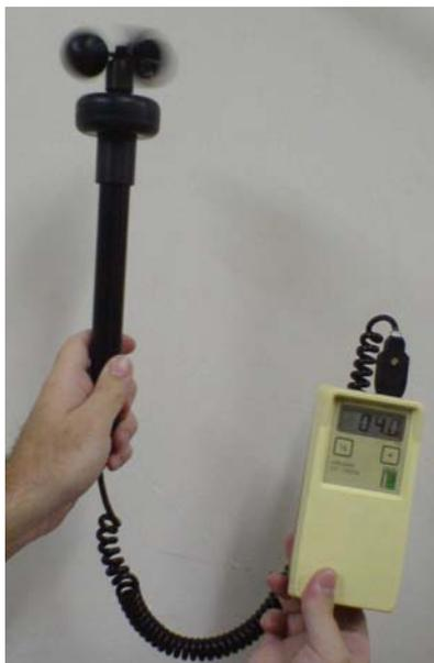
Figura 3.2 - Anemômetro portátil.
