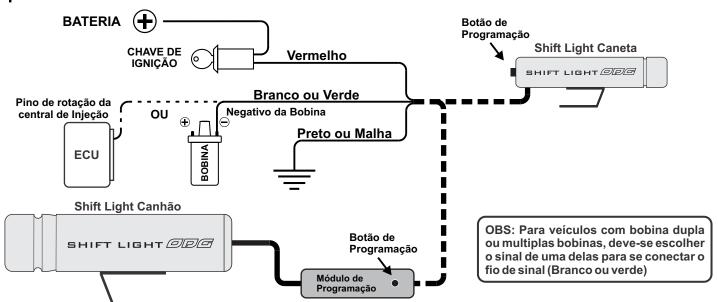
**MODO CANETA DE PROVA:** Após a instalação, para verificar se o sinal de rotação está sendo lido corretamente ligue o veículo e em marcha lenta dê um clique rápido no botão de programação. O LED deverá ficar piscando rapidamente, na frequência do sinal de rotação. Para sair deste modo basta clicar novamente no botão de programação.
