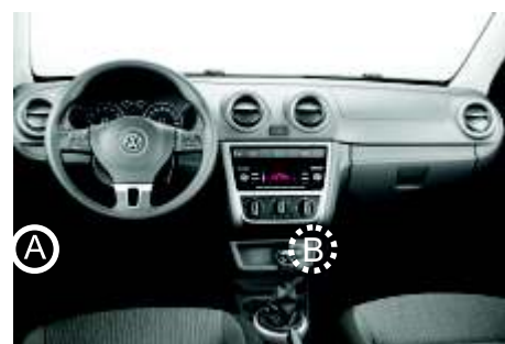
12. São apenas quatro cabos soltos no chicote. Dois serão ligados no círculo A (Positivo - VM, Lanterna - CZ/VD), no círculo B (Terra - MR), vai sobrar o fio CZ que será para ligar no CZ do alarme.
