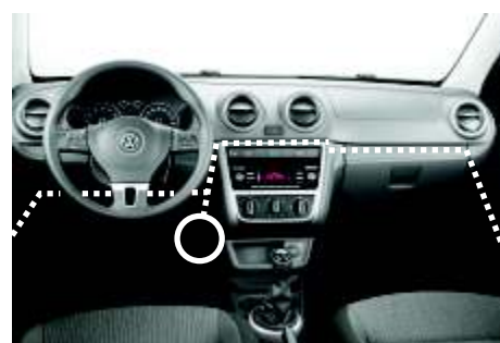
10. A linha pontilhada é uma base por onde passar o chicote do kit vidro, sempre siga o chicote original do carro para facilitar. O círculo mostra onde esta posicionado o módulo de conforto.
