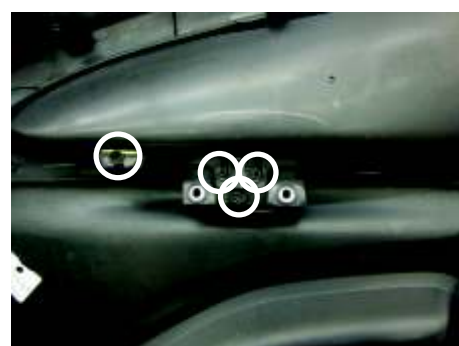
14. Utilizando uma furadeira com uma broca de 6mm remova o puxador atual através dos pontos indicados, cuidado para não danificar o revestimento da porta.
