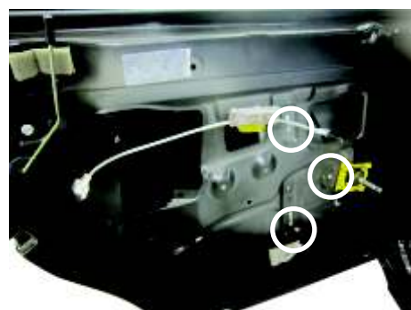
3. Utilizando uma furadeira com uma broca de 6mm remova os 3 rebites indicados conforme a figura acima, retire o mecanismo pela parte inferior da porta.
