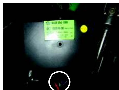
11. Esse é o módulo original 2 portas que deve ser fixado próximo a coluna de direção encaixando o conector de 23 vias do módulo conforme figura acima.
