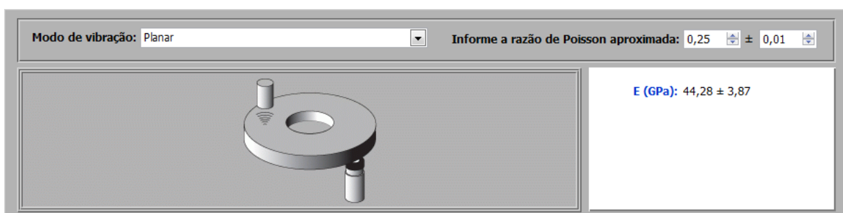
Figura 34. Módulo do Software Sonelastic® com a opção “Planar” selecionada. Exemplo de medição de uma amostra de rebolo.
