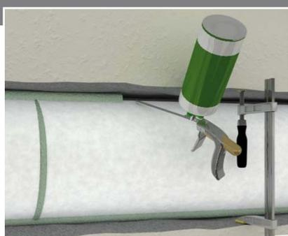
**10** Coloque espuma PU também entre placas FLEXOTERM, assim como nos espaços entre a placa de isolamento e a parede.
