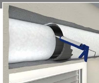
**6** Instalação da placa de isolamento. As extremidades da placa precisam ser fixas através de um colchete ou outro travão apropriado.
