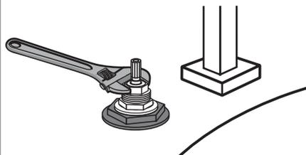
**6** Coloque a canopla, rosqueie o prensa-canopla, encaixe o acabamento, se estiver alinhado pressione até "clicar", caso contrário repita os passos do 1 ao 6.
