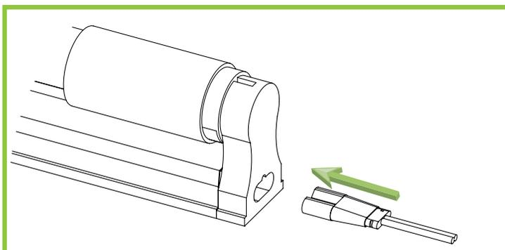
Insira o pino de alimentação elétrica em uma das extremidades da calha.
