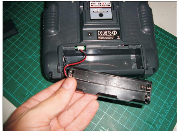
2 - Ao conectar a bateria no rádio, sempre plugue o conector preto da bateria seguindo a mesma ordem de cores da fiação do Pack de pilha já instalado (fios Preto e Vermelho), **muita atenção para não ligar o plug invertido das cores dos fios**, isso queimará a placa principal do rádio, causando um dano sério no rádio, o qual não cobre garantia do fabricante do rádio.
