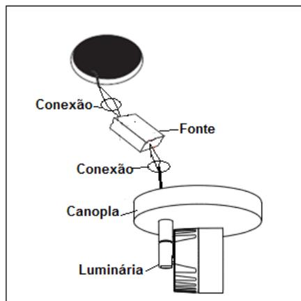
4. a) Encaixar a fonte no furo do forro e fixar suporte, rosqueando os parafusos.
