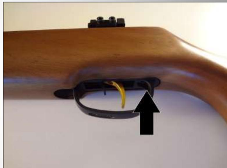
Com chaves adequadas a sua carabina (Philips ou fenda), remova os três parafusos da coronha para separar a coronha da mecânica da carabina. Dois parafusos estão localizados nas laterais e o último atrás do guarda-mato.
