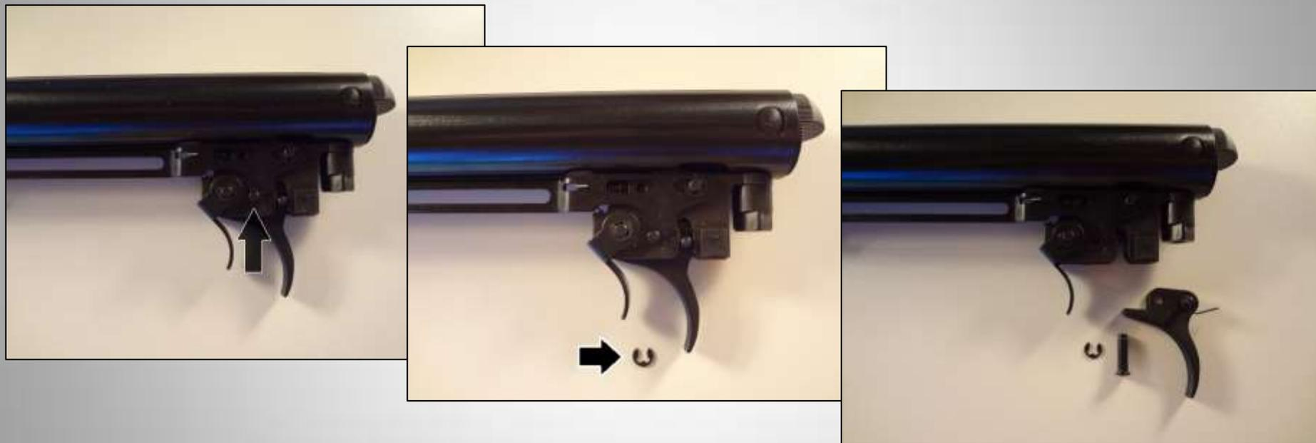
Com uma chave de fenda pequena ou uma chave de ponta fina, remova apenas o anel elástico da lâmina do gatilho, conforme ilustrado na foto. Ao remover o pino, a lâmina de gatilho original será liberada. Retire completamente a antiga lâmina da caixa de gatilho.
