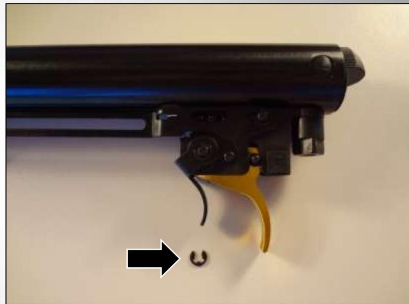
Encaixe o pino de segurança, retirado da antiga lâmina de gatilho e encaixe na nova lâmina de gatilho ajustável.
