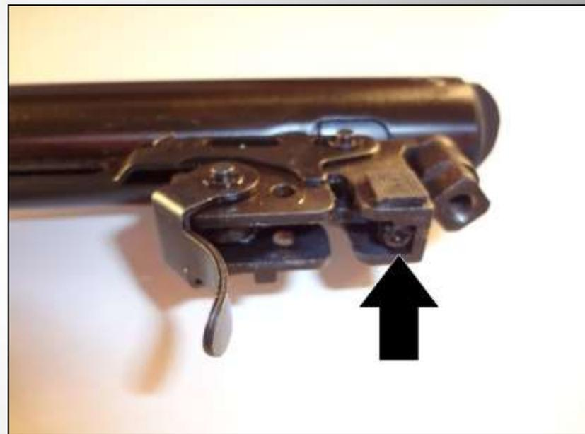
Retire o pino de segurança que atua na trava de segurança da carabina, da lâmina do gatilho. Este pino será instalado na nova lâmina ajustável.
