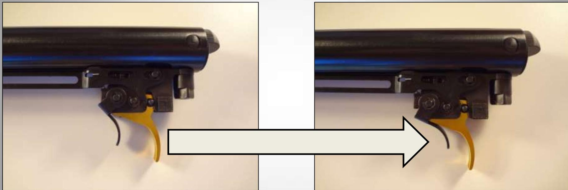
Para assegurar que o sistema de travamento do gatilho esta operando normalmente após a instalação da nova lâmina de gatilho execute o procedimento abaixo:
