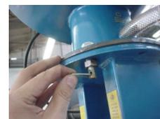
3 – Com o filtro fixado e o flange, colocar as duas abraçadeiras de 6 ou 8 polegadas no tubo e prender uma no bocal frontal do filtro e outra no flange. Para esta fixação não é necessário colocar silicone, apenas aperte as abraçadeiras.
