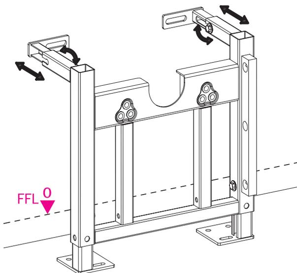
2. Ajuste a distância requerida para a parede. Afrouxe os parafusos de regulagem para a parede, ajuste para a distância requerida, verifique se a moldura está na vertical e aperte novamente os parafusos.
