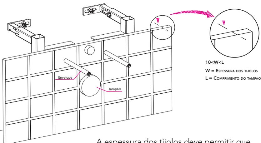
A espessura dos tijolos deve permitir que os tampões sejam facilmente retirados. O tampão do encanamento preparado pelo consumidor deve ter comprimento suficiente.
