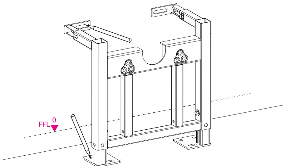
3. Marque as posições de fixação na parede e no piso. Remova a moldura e fure os buracos adequados ( $\phi$  10 X 50) para as fixações.
