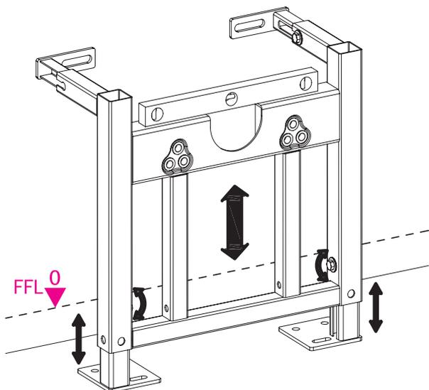
1. Coloque a moldura contra a parede na posição requerida. Afrouxe os parafusos de regulagem de altura, ajuste na altura requerida, verifique se a moldura está nivelada e aperte novamente os parafusos.
