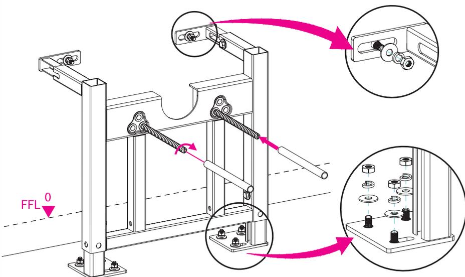
4. Coloque a moldura na posição requerida novamente, trave a base da parede e a base do piso bem apertadas. Verifique se a moldura está nivelada em todos os sentidos. Como é necessário, escolha os orifícios corretos para inserir os parafusos longos e então coloque os protetores.
