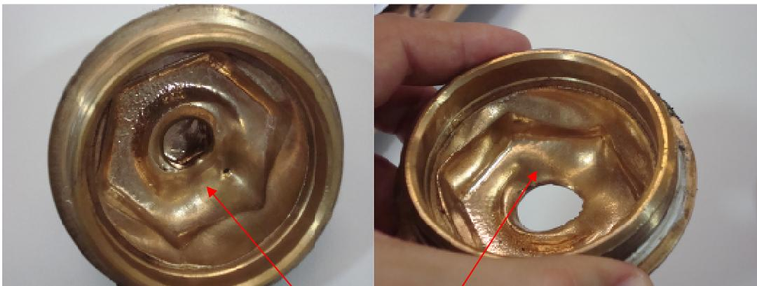
Desgaste da peça em função da cavitação
