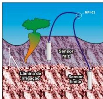
Posicione o sensor no fundo do buraco, horizontal ou verticalmente, pressionando o solo com os dedos em volta do sensor até garantir um contato completo com os mesmos. Devolva o solo no buraco, socando-o até obter a mesma compactação original.
