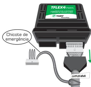
2) Conectar o chicote de emergência no chicote do conversor FLEX, reestabelecendo a conexão original no sistema de injeção do veículo.
