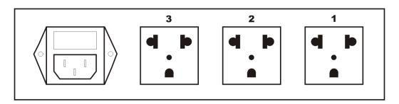
**Entrada de Energia e Porta-Fusível** – Conector para cordão de energia com porta-fusível acoplado. O compartimento acomoda um fusível de 20A em uso e outro de reserva.
