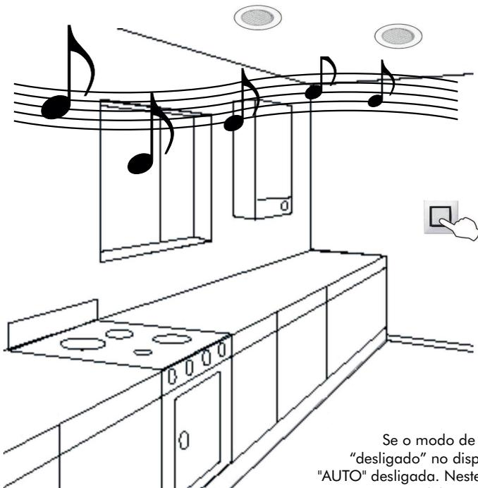
Esta função está pensada para o caso da alimentação de rede do **COCIBAÑO® iSelect** ser tomada através de um interruptor destinado a esse efeito. Neste caso, se se desejar que **COCIBAÑO® iSelect** se acenda automaticamente ao actuar sobre esse interruptor, deve programar-se o modo de arranque automático.
