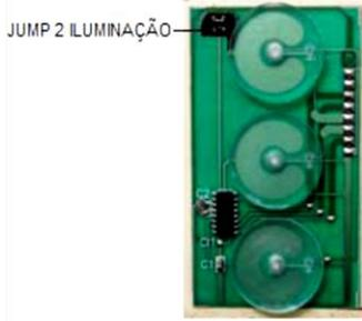
Para iniciar a configuração do interruptor, os disjuntores deverão ser desligados, pois o interruptor só reconhece as configurações quando ele for energizado novamente.
