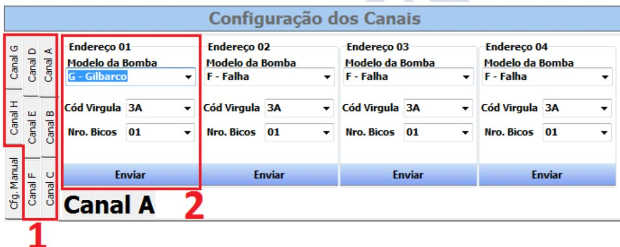
Figura 31 - Configurando bombas.
